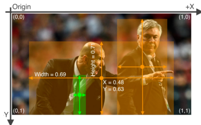
Fig. 2. Representación de bounding box con distintas clases [12].
