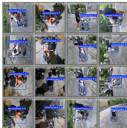
Fig. 11. Predicción de las imágenes de validación durante el entrenamiento.
