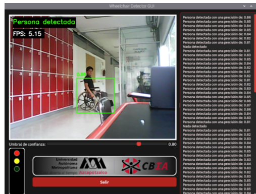
Fig. 12. Detección de silla de ruedas con umbral del 80 % a 4.5 metros de distancia.
