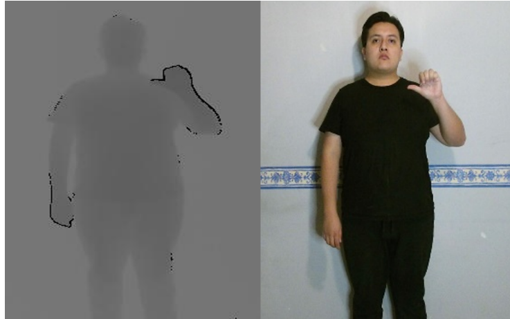
Fig. 9. Imagen de color y de profundidad captada por el Kinect v2. En la imagen se representa la seña de la letra “A”.
