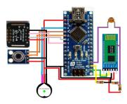
Fig. 10. Diagrama eléctrico de conexión.
