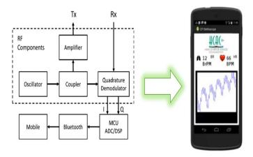
Fig. 3. Diagrama a bloques del sistema y datos desplegados en un dispositivo móvil [7].
