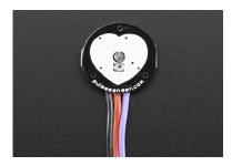
Fig. 5. Sensor de pulsos ADA-1093.
