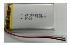
Fig. 9. Batería par alimentar al sistema.
