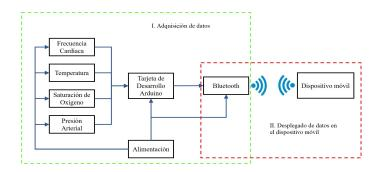
Fig. 1. Diagrama a bloques del funcionamiento del sistema.
