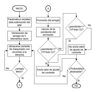
**Fig. 4.** Diagrama de flujo para ajuste de distancia inter-electrodos con base en el valor de la pendiente en la corriente de maquinado.
