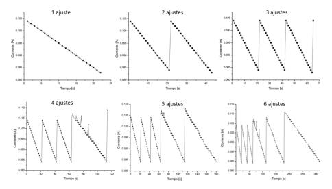
**Fig. 2.** Comportamiento de la corriente de maquinado: tras cada ajuste, el tiempo necesario para actualizar el valor de la corriente se incrementa debido al error en la estimación de la distancia inter-electrodos.
