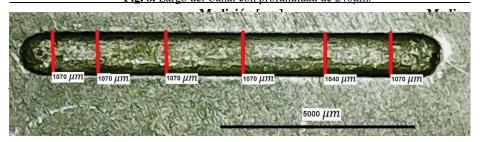
Fig. 9. Ancho del canal con profundidad de 240  $\mu m$ .
