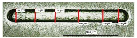
Fig. 11. Ancho del canal con profundidad de  $500 \mu m$ .
