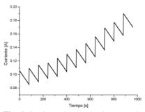
**Fig. 6.** Corriente de maquinado en prueba de 240 μm de profundidad.
