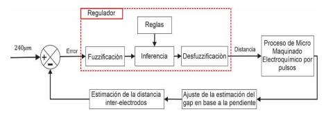
Fig. 5. Modelo SISO del sistema control implementando reajuste por pendiente.
