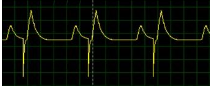
Fig. 5. Resultado en la simulación del circuito con el programa Multisim ver.13 obteniendo la representación de la señal ECG.
