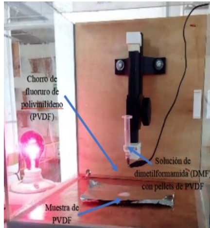
Fig. 2. Máquina de Electrospinning durante el proceso de inyección de la capa de material PVDF.
