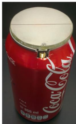
Fig. 6. Satélite en lata con antena semicircular de parche con elemento parásito.
