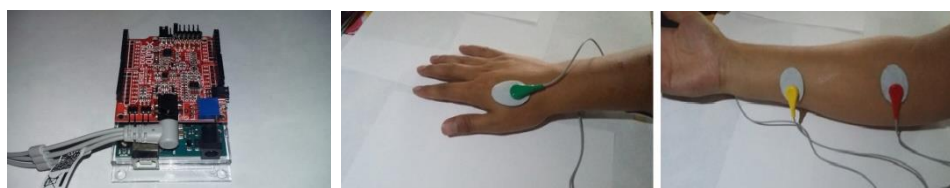
Fig. 2. Montaje de la tarjeta de desarrollo Arduino Uno Wifi y tarjeta shield EKG/EMG.
