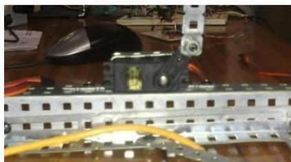
Fig. 3. Ubicación de los motores para posicionamiento del laberinto.
