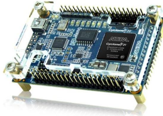
Fig. 3. Tarjeta de desarrollo DE0-Nano, de 7.5 \times 5 .
