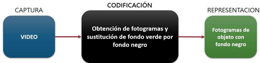
Fig. 8. Diagrama cibernético de primer orden, es decir, entrada, proceso, salida del subsistema de procesamiento de imágenes.
